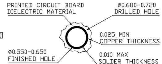
RECOMMENDED PC BOARD REQUIREMENTS (COMPONENT SIDE BOARD SHOWN)
